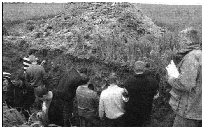
«Sur un profil de sol, on apprécie à la fois la compaction, la température, le pH, la fraîcheur, la couleur et l'enracinement, tout ça régulièrement sur 2 m», explique Christophe Frebourg (à d.), expert en profils de sol.
